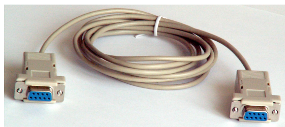
Figure 72 - Câble modem NUL (câble croisé)
