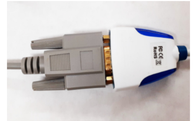
USB dönüştürücüye RS232'ye bağlı 9 Pin Çapraz kablo.
