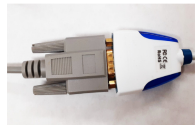
Câble croisé à 9 broches attaché au convertisseur RS232 vers USB.
