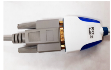
Καλώδιο Crossover 9 ακίδων συνδεδεμένο στον μετατροπέα RS232 σε USB.
