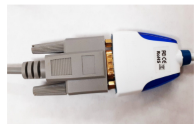
Cavo crossover a 9 pin collegato al convertitore da RS232 a USB.
